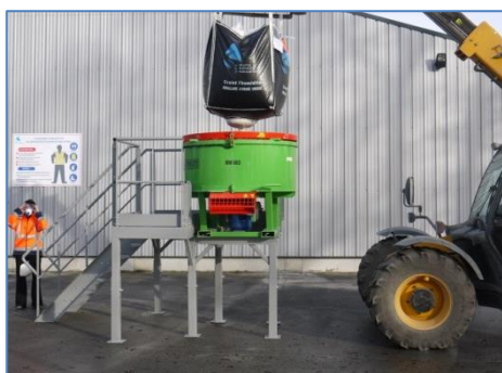
MINI-CENTRALE À BÉTON
